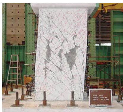
せん断破壊試験状況
