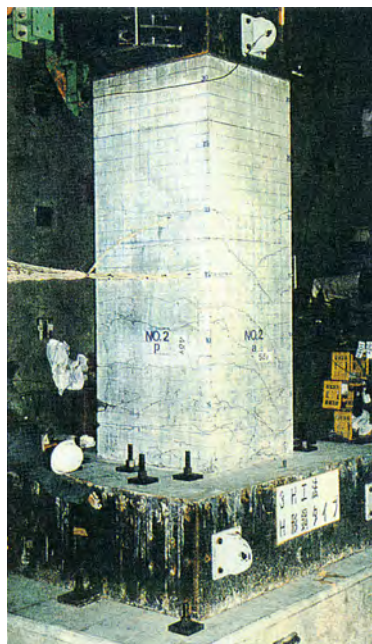
正負交番水平载荷試験状況 (試験は試験体を横にした状態で行っています)
