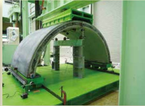
セグメント継手曲げ試験
