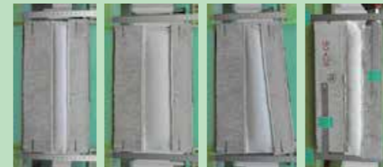
初期状態 軸方向変位30mm 軸方向変位差30mm せん断方向変位10mm
