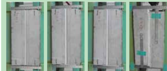
初期状態 軸方向変位5mm 軸方向変位差5mm せん断方向変位10mm
