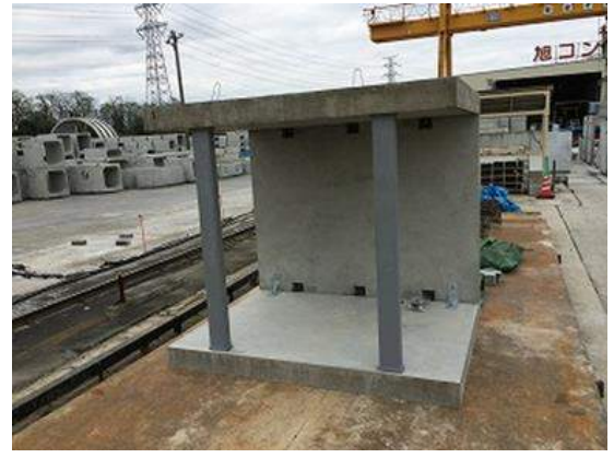
3枚のコンクリート版で、下、横、上向き3面の性能を確認する供試体
