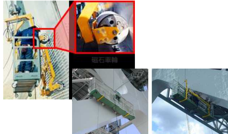
(日本) 磁石車輪ゴンドラ 「本四高速:長大橋の保全技術 (維持管理編)」より
