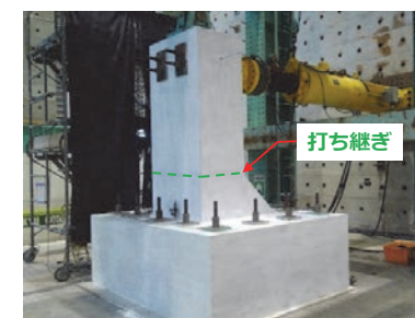
写真-4 現場打ちボックスカルバート
