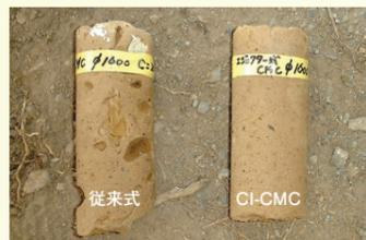
図4 従来工法とCI-CMC工法のコア比較
