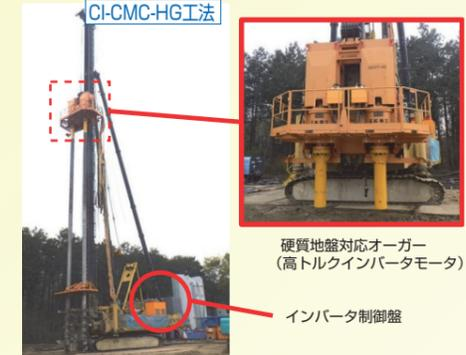
図8 CI-CMC-HG施工機・超硬質対応オーガー
