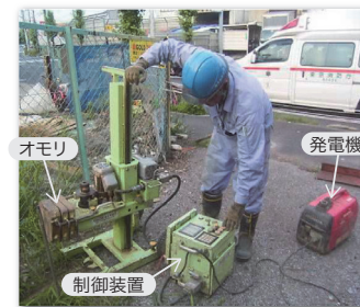
図8 SWS試験の実施状況
