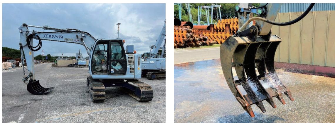
テノキューブ工法の施工機および掘削攪拌装置
