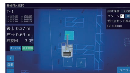
施工機の位置誘導画面 例
