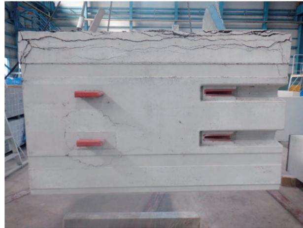
写真-2 セグメント継手曲げ試験\_終局曲げ圧縮破壊後の継手面のひび割れ状況
