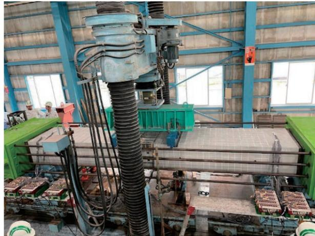
写真-1 軸力を導入したセグメント継手曲げ試験状況
