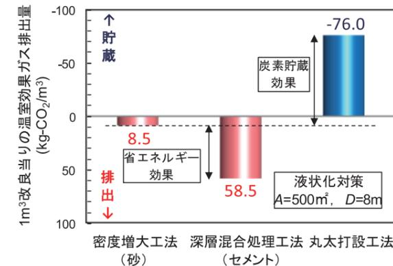
1m<sup>3</sup>改良工場の温室効果ガス排出量と貯蔵量の収支
