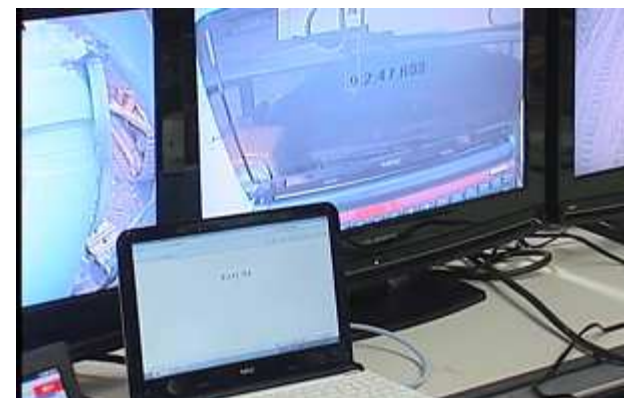
重機から送られてくる時刻と操作室の時刻を確認する。
