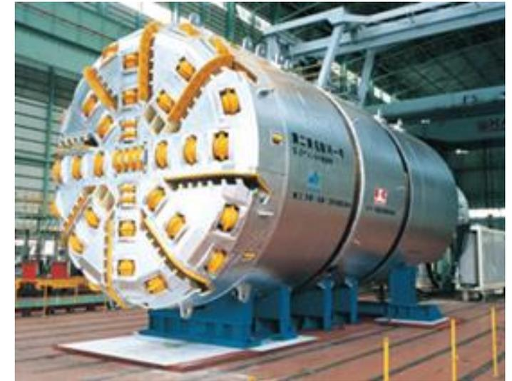
TBM(全断面型)
