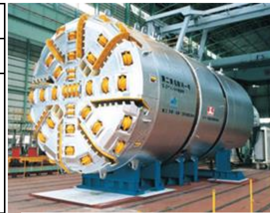
TBM(全断面型)
