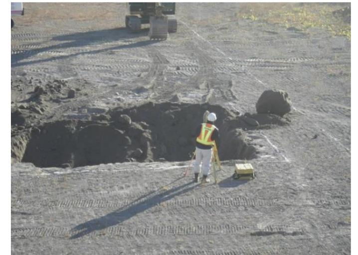
試験後の計測状況（3Dスキャナ）
