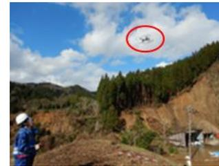
▲ドローンによる土砂災害調査
