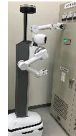
ロボットによるリモート設備検査
