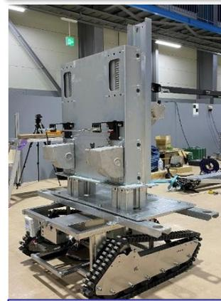
簡易支柱運搬機構
