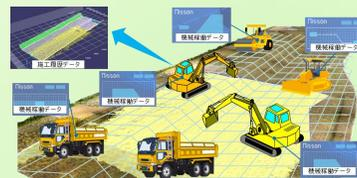
建設機械施工の自動化
