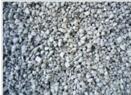
再生コンクリート骨材
